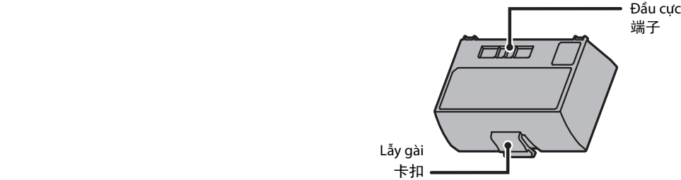
Hình ảnh minh họa cách lắp đặt đúng cách của pin lithium-ion.
